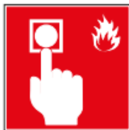
Point d'alarme incendie
