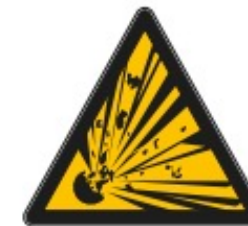
Matières explosives Risque d'explosion
